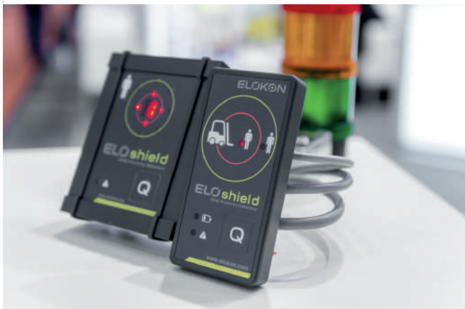
Nowe możliwości ELOshield: kompleksowe ostrzeżenie z rozpoznaniem przeszkody w zakresie 360° prezentowała firma ELOKON (fot. ELOKON)
