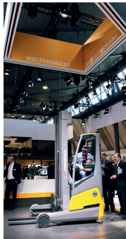
Wózek wysokiego składowania ETV 216i ze zintegrowanym akumulatorem litowo-jonowym od Jungheinrich (fot. EUROEXPO)
