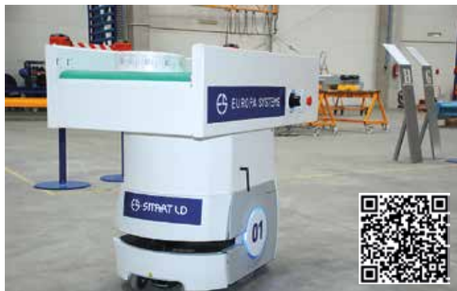
ES Smart to w pełni autonomiczny, inteligentny wózek transportowy (Autonomous Intelligent Vehicle) pokazany przez Europa Systems (fot. Europa Systems)
