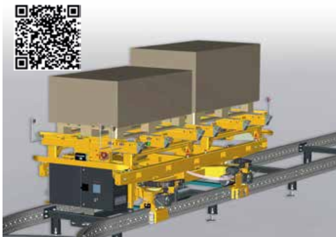
Urządzenia automatyzujące prace magazynu znalazły się też na stoisku firmy Eisenmann. TwinShuttle to podwójne wózki regałowe, poruszające się wahadłowo. Ruch odbywa się na wspólnej szynie (fot. Eisenmann)
