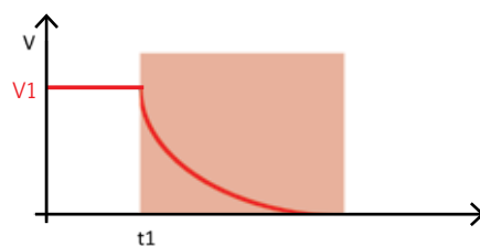
Ryc. 1. Zależność zmiany prędkości w czasie po wywołaniu funkcji STO w napędzie elektrycznym
